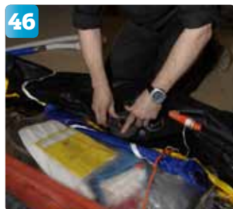
När flotten är tömd på luft sätts gummiskydd på övertrycksventilerna för att undvika att de skaver mot gummit.
