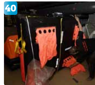
Här kontrolleras de fyra orangea påsar som hänger i varje hörn. När de vattenfylls gör de flotten stabilare. Den gula linan under flotten kan användas till att välta flotten rätt om den ställer sig på kant.
