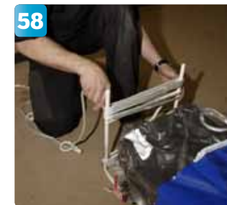
Den grövre linan lindas runt en ställning så den får formen av en åtta.
