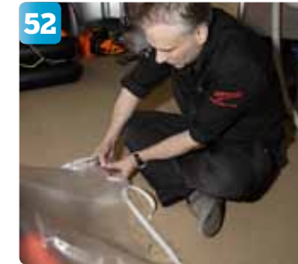
52 Vakuumpåsen är fortfarande öppen. I änden läggs ett svart tätningssband som trycks ihop noggrant för att få ut alla luftbubblor.
