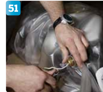
51 Snöret från tuben träs utanför vakuumpåsen och när allt är på plats dras muttern fast.
