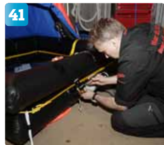
Tuben monteras tillbaka och kopplas in mot båda flytkammarna.
