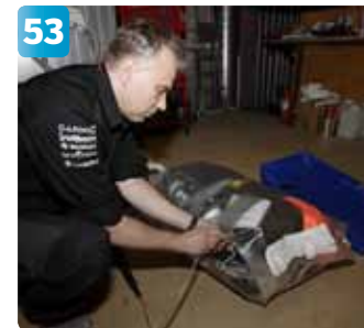
Nu ska vakuumpåsen ner i den blå väskan. Vakuumsugen ansluts igen för att få ut den sista luften och göra det lättare att packa ner flotten i väskan. Dessutom minskar risken för fukt och mögel om det är tomt på luft.
