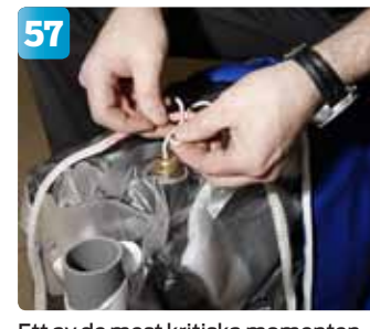
57 Ett av de mest kritiska momenten. Den tunna linan till utlösningssmekanismen ska knytas fast i den grövre kastlinan. Det är viktigt att få det så dikt mot mekanismen som möjligt. Här gäller det att vara lugn. Det är lätt hänt att rycka till och därmed lösa ut hela flotten.
