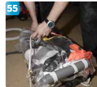
55 Det grå röret sätts fast. I den ska den grövre linan ligga.
