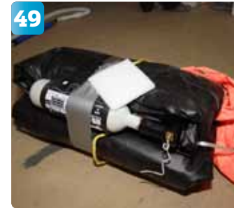
49 Ett plastskydd sätts utanpå tubens utlösningssanordning för att skydda den. Sedan läggs ytterligare ett skydd (den vita fyrkanten) utanpå för att skydda den känsliga utlösningssanordningen på tuben.
