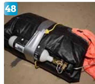
48 Till slut blir det ett snyggt litet paket. Silvertejpen sprängs sönder när flotten löses ut.
