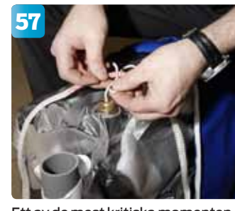
Ett av de mest kritiska momenten. Den tunna linan till utlösningssmekanismen ska knytas fast i den grövre kastlinan. Det är viktigt att få det så dikt mot mekanismen som möjligt. Här gäller det att vara lugn. Det är lätt hänt att rycka till och därmed lösa ut hela flotten.
