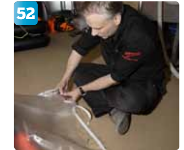
Vakuumpåsen är fortfarande öppen. I änden läggs ett svart tätningssband som trycks ihop noggrant för att få ut alla luftbubblor.
